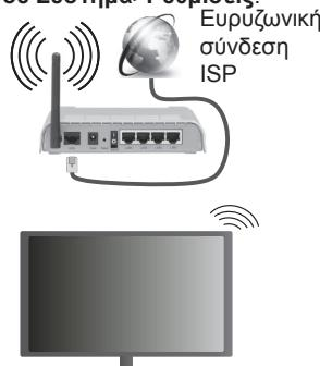
Ένα ασύρματο ρούτερ N (IEEE 802.11a/b/g/n) με ταυτόχρονες ζώνες συχνοτήτων 2,4 και 5 GHz είναι σχεδιασμένο για αύξηση του εύρους ζώνης. Αυτά
